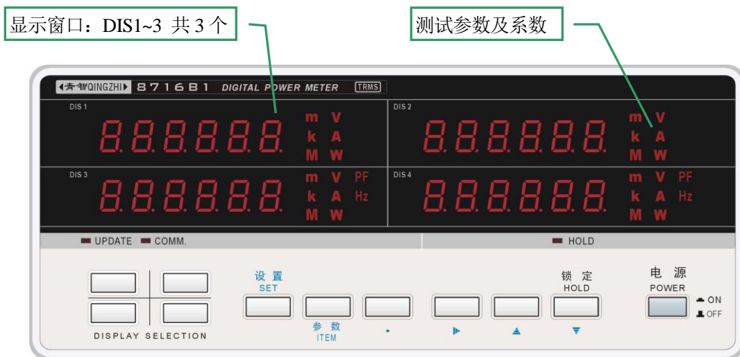
图 2 8716B1 仪表前面板示意图
