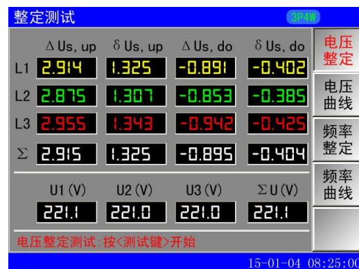
图 9-1 电压整定测试-数据
